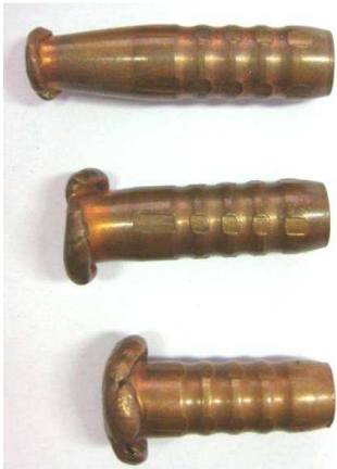
Expandierte AERO Geschosse bei verschiedenen Geschwindigkeiten. <600 m/s 700 m/s 800 m/s
