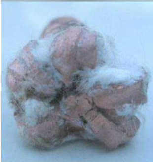
AERO SB 323-165 mit 8mm tiefer HS nach 6cm dicker Gelatine mit >800 m/s
