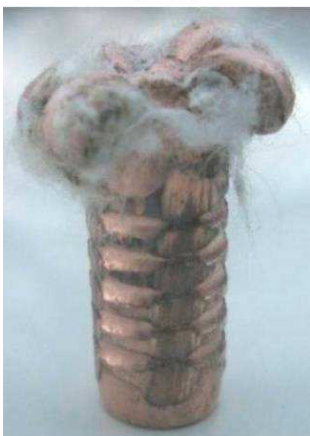
Expandierte AERO Geschosse bei verschiedenen Geschwindigkeiten. <600 m/s 700 m/s 800 m/s
